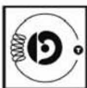
Slika 1.21: Oznaka za induktivnu petlju i transmisioni obruč
